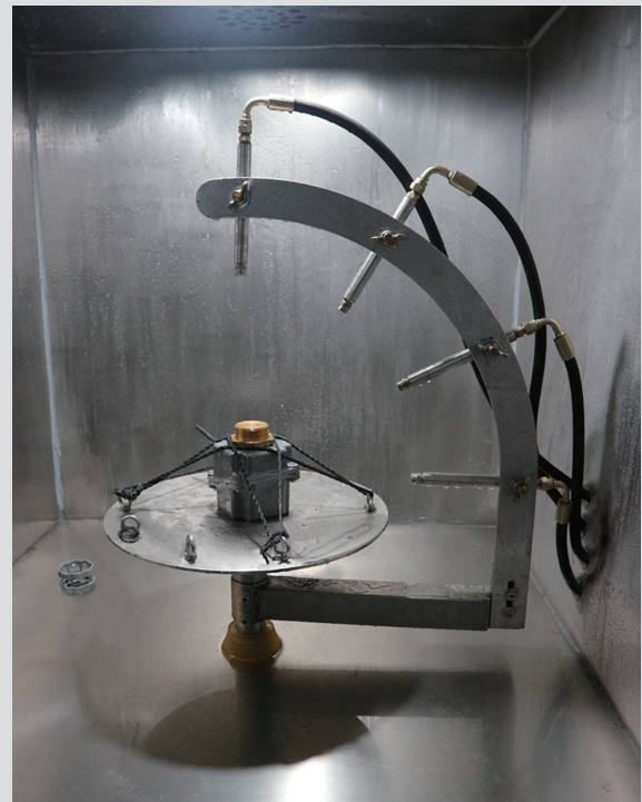
Gehäuse bei IPx9k-Test
