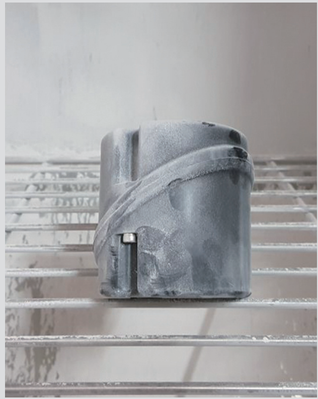
Gehäuse bei IP6x-Test
